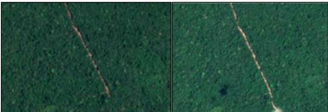
Figura 6. Imagen Planet del 26 de Septiembre 2021 (Izquierda). Ancho de vía aprox de 10 a 12 metros; imagen planet del 24 de octubre de 2021 (derecha)- Ancho de vía de 20 a 22 metros
