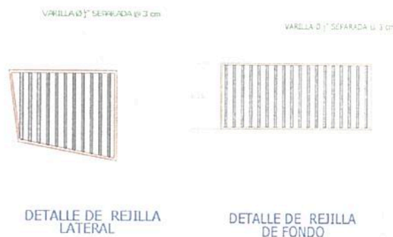
Imagen 1. Dimensiones rejillas. Fuente: EPSA
