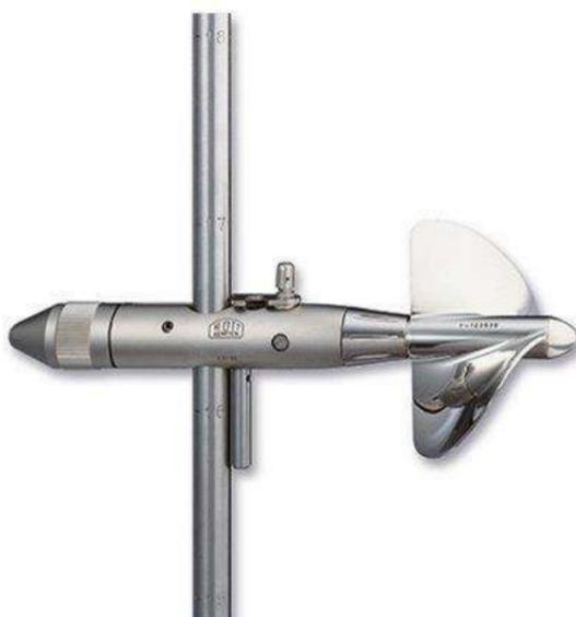
Figura 1. Correntómetro de tipo paleta curvada (OTT C31).
