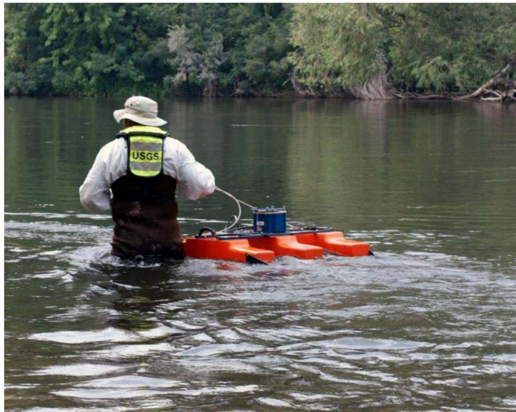
Figura 4. Medidor de caudal tipo ADCP (Alvin ADCP).
