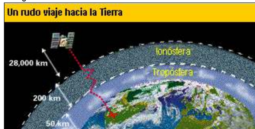
Figura 4. Factores atmosféricos de interferencia de la señal.
