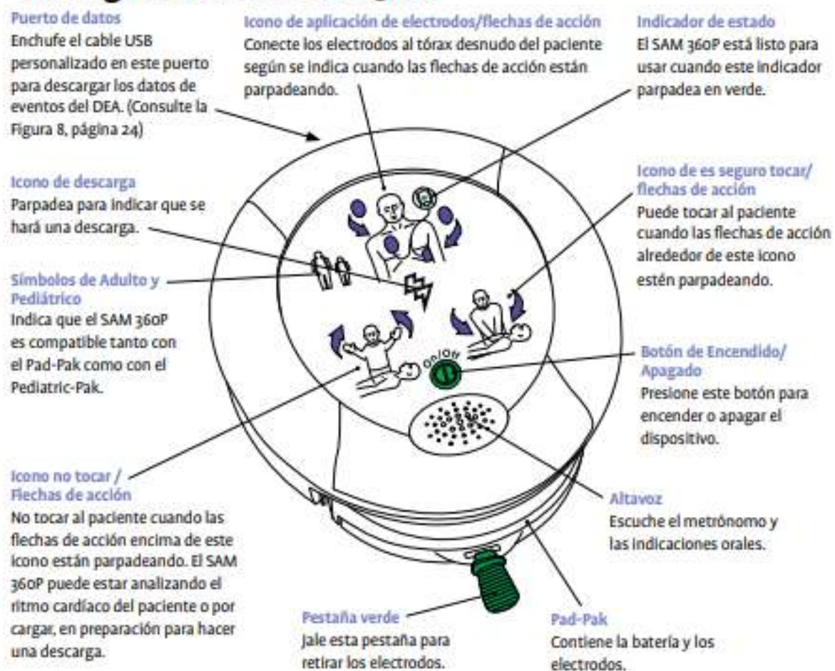
Ilustración 1. Partes del DEA
