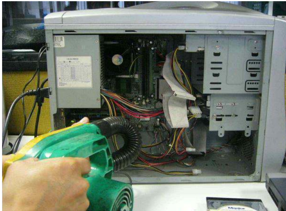
Imagen 6: Inicio de mantenimiento con limpieza
