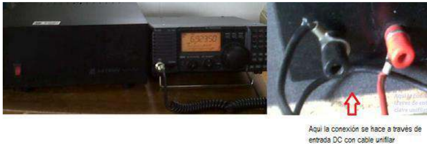
Ilustración 6 Conexión equipo base a fuente reguladora
