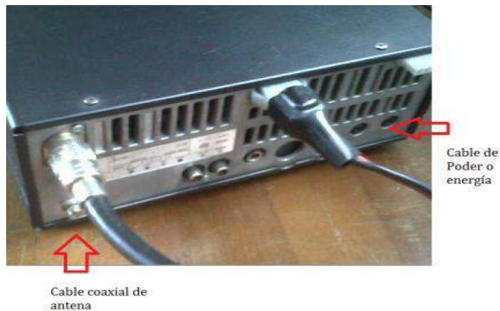
Ilustración 7 Conexiones del equipo con sus elementos (micrófono, cable coaxial-antena, cable de poder).
